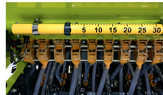
Išsėjimo noragėlių prispaudimo jėga gali būti reguliuojama mechaniškai arba hidraulinio būdu. S serijos noragėlių ji nedidelė, apimanti 5–30 kg diapazoną (nuotraukoje), nes sėjamoji skirta sėjai į gerai paruoštą dirvą, atskirais atvejais – į minimaliai dirbtą dirvą
