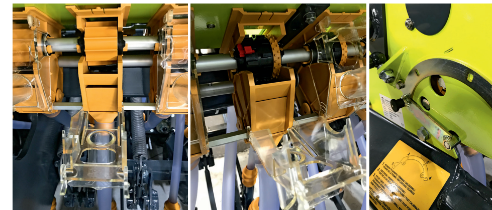
Trąšoms išberti naudojami ritiniai rievėti (kairėje), o juauraus stambumo sėkloms – ritiniai krumpliniai kombinuojami sėjamieji aparatai (viduryje), sudaryti iš kelių, skirtingų matmenų krumpliuotų ričių. Ritės tarpusavyje sujungiamos ir atjungiamos įstatant arba ištraukiant atskirai kaiščius (nuotraukoje jie raudonos spalvos). Kiekvienos ritės apačioje yra perstatomas dugnelis, kurio padėtis keičiama sėjamosios kairėje įrengta svirtimi. Iš viso yra keturios padėties: O arba dugneliai pakelti aukštyn – smulkios sėkloms, 3 arba nuleisti žemyn – stambioms sėkloms, pavyzdžiui, pupelėms
