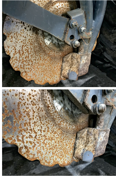
Diskinis M serijos noragėlis, kada trąšų įterpimui naudojamas vienas, tas pats noragėlis. M serijos sėjamosiomis galima sėti ir į visai neruoštą dirvą, tiesiai į ražieną, nes naudojami diskai su išpjaustytais ašmenimis, geriau pjaunantys ant dirvos paviršiaus esančias augalų liekanas. Svarbi detalė – labiausiai apkrautoje sėklavamzdžio antgalio apatinėje dalyje prilituota dilimui atspari kietlydinio plokštelė. Nuotraukoje 2014 m. pagamintos sėjamosios M300 Plus noragėliai
