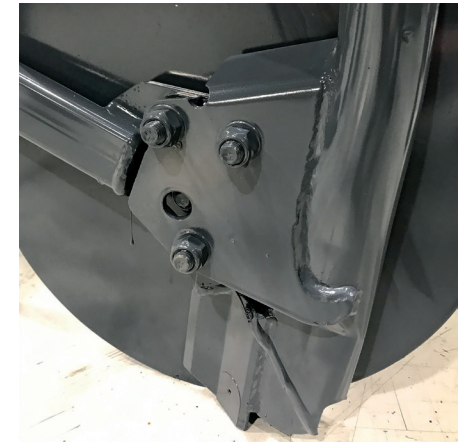
Diskinis S serijos noragėlis: atkreipkite dėmesį į tris sėklavamzdžio tvirtinimo prie pavaldžio taškus. Jais reguliuojamas tarpelis tarp disko ir valiklių ašmenų, tačiau normaliomis sąlygomis to daryti nereikia
