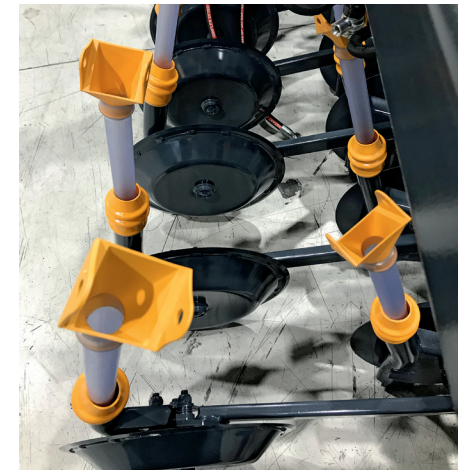
S (nuotraukoje) ir M serijos noragėlių šonuose privirinti išgaubtos formos atraminiai diskai, atstojantys gylio ribotuvus
