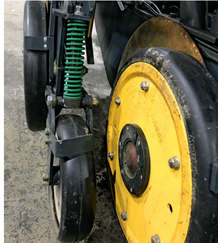
Sunkiausioms darbo sąlygoms – sėjai ne tik į paruoštą dirvą, bet ir tiesiai į ražieną – skirtas D serijos dvidiskis noragėlis. Gerai matyti išsėjimo noragėlio šone esantis atraminis, gylio reguliavimo ratas, kuris įrengtas su nedideliu pastūmimu atgal. Už jo – reguliuojamas prispaudimo ratukas (volelis) su spyruokline pakaba. Pasak suomių, Junkkari ir Väderstad išsėjimo diskų tiekėjas tas pats
